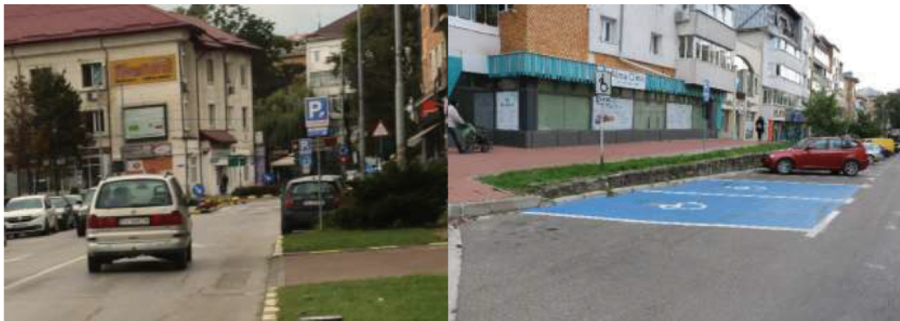
Figura 2.70. Semnalizare loc de parcare cu autotaxare și pentru persoane cu handicap. (exemplificare).
